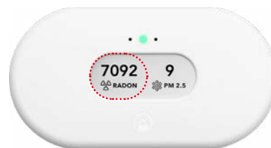
Airthings s kontrolní naměřenou hodnotou v rámci protiradonového systému
