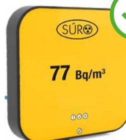
Hodnota měřená po instalaci protiradonového systému prováděného SÚRO
